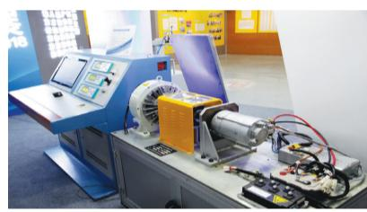
**电动汽车动力系多功能测试平台**
