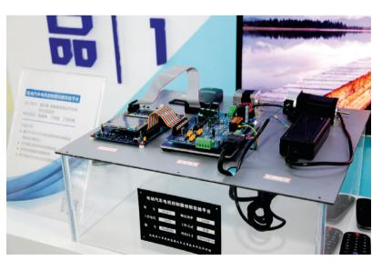
**电动汽车电机控制器创新实验平台**
