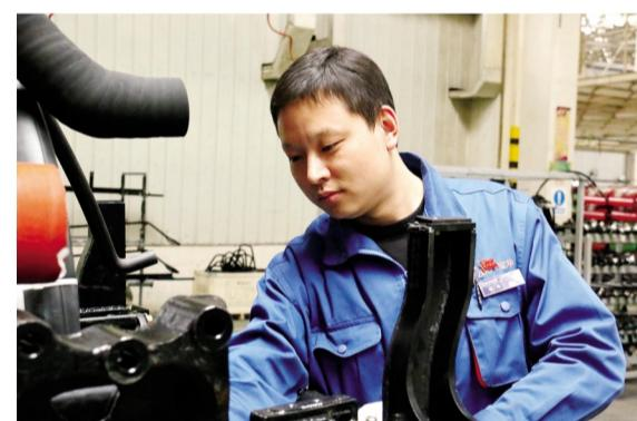
零部件的质量可以说是“锱铢必较”。他经常告诫职工，“每一台下线车辆都像自己的孩子，从材料选用到装配成型，每道工序都需要我们悉心呵护，认真对待，不要放过任何一个细节。”一次他在抽检中发现方向机十字轴力矩要求53-66NM，抽查为67NM，超差1NM，他立即要求整改，“行就是行，不行就是不行，没有‘还可以’‘差不多’”胡炜严肃的说到。正是他这种“一根筋”死磕质量的较真劲，为装配车间树立起
