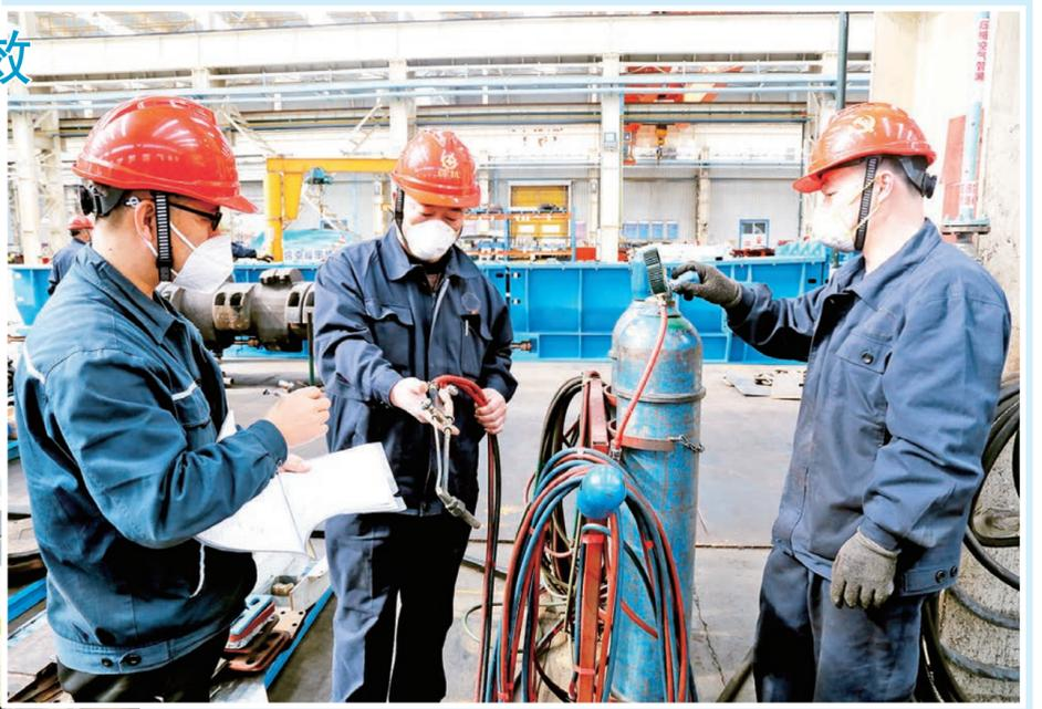
►近日,黄骅港务物流中心开展了流动机械专项养护工作,涉及轴承铰点注油、钢丝绳检查更换、电气线路检修、液压系统保养等工作,为安全高效生产提供设备保障。图为技术人员向较点加注润滑油。
