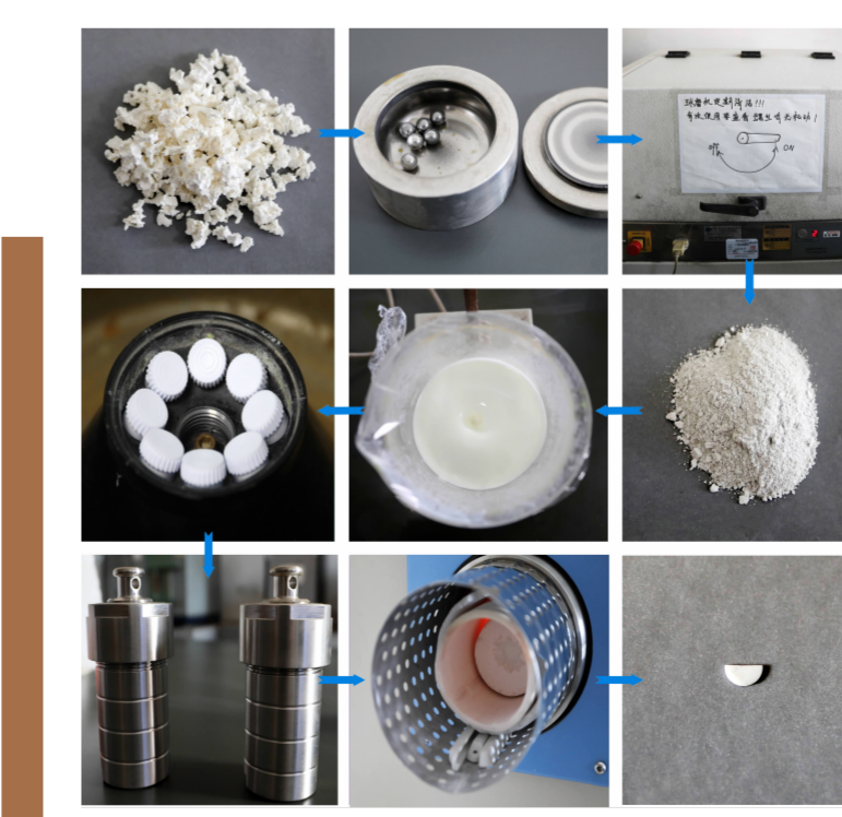
团队目前使用的主要制备方法:将氧化铝陶瓷粗料装入磨料盒——用行星式球磨机磨制 20 小时以上得到纳米级颗粒——装入不同浓度的盐酸中进行分离沉降——将沉淀液放入试管——离心机离心——得到尺寸相近的纳米刚玉颗粒干燥后得到粉末——将粉末装入模具压制——高温煨烧——得到圆形的细晶氧化铝纳米陶瓷
