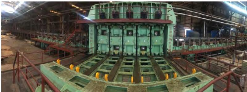
造、主传动系统的设计制造等一系列关键技术,采用最先进的单独传动智能控制技术,解决了定径机设备制造中的关键技术和关键工艺,在试车中的各项技术指标均达到设计要求。
