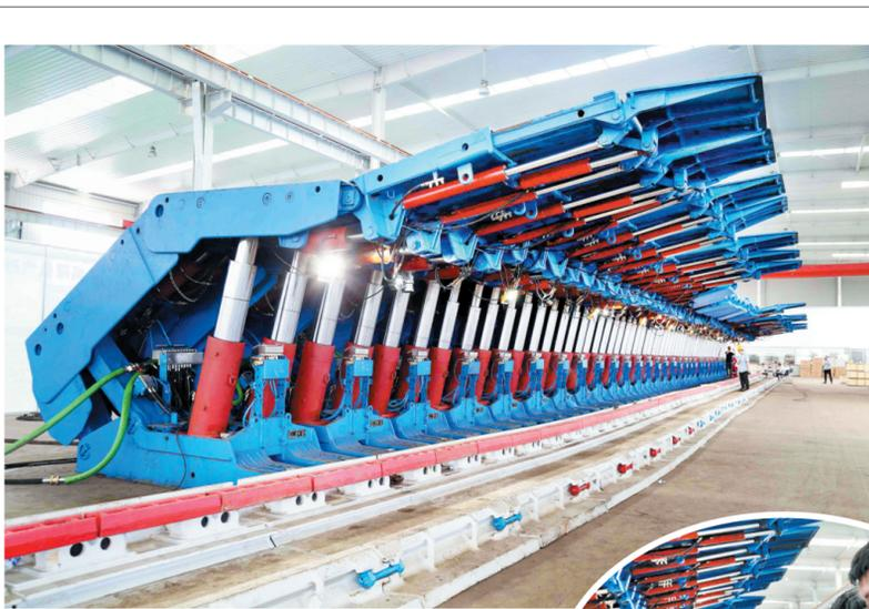
连日来，中煤大屯煤电公司徐矿矿对8331智能化工作面综采支架和设备在实业公司产业园进行联合调试。为确保设备调试后正常运行，矿工程技术人员冒着炎热酷暑对所有设备进行精心安装调试，现已完成第一阶段调试工作。 通讯员 靳西平 摄
