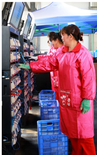
放线员检测回收节点检波器
