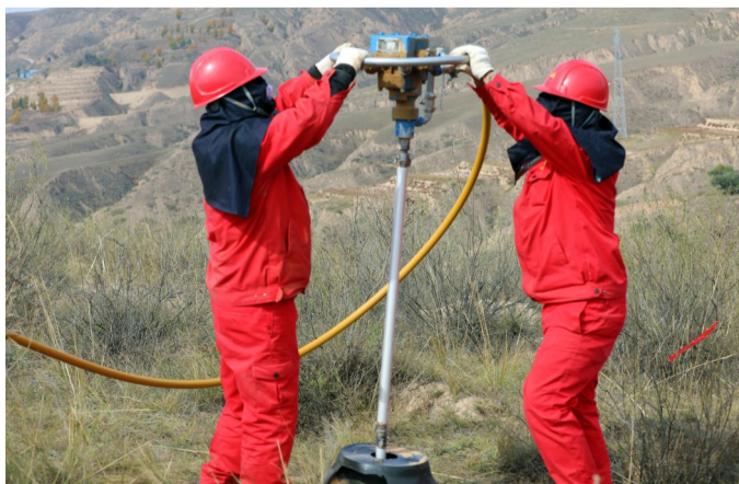
钻井用CQ-HTZ-20型钻机打井作业
