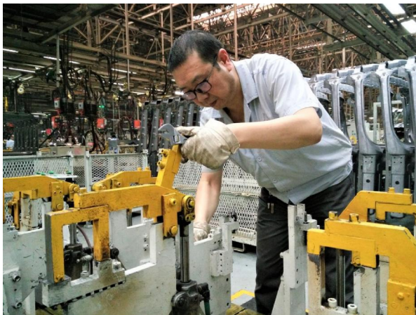
李晓正在检修夹具夹紧后的标准工艺间隙
