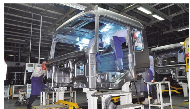
装焊车间FB生产线上的员工们按规定穿戴好劳保用品，专注焊接驾驶室，既保安全，又保产量
