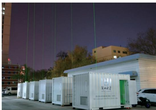
兰州大学城关校区装有雷达的白色观测箱发出的激光
