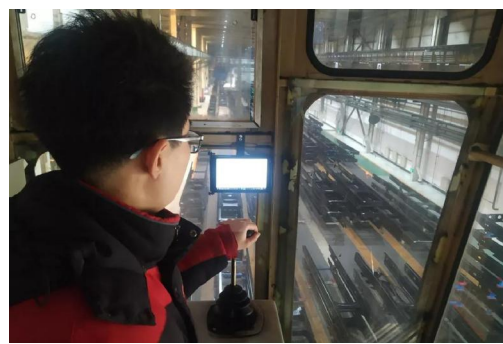
天车工通过驾驶室显示终端便可快速获取车架及床位信息
