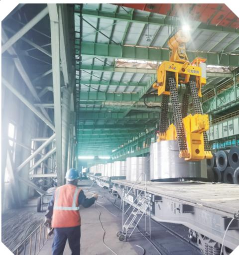
近日,宏兴股份产成品服务分公司不锈钢嘉东作业区热轧库装车专用电动翻转夹钳正式投入运行。该设备的使用,简化了作业流程,避免了因翻卷作业而造成碰伤卷板外观质量的问题,同时降低了作业人员的劳动强度,保证了作业现场本质安全。
