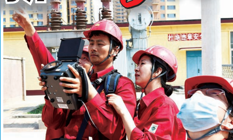
员工用紫外线成像设备及时判断电网放电位置
